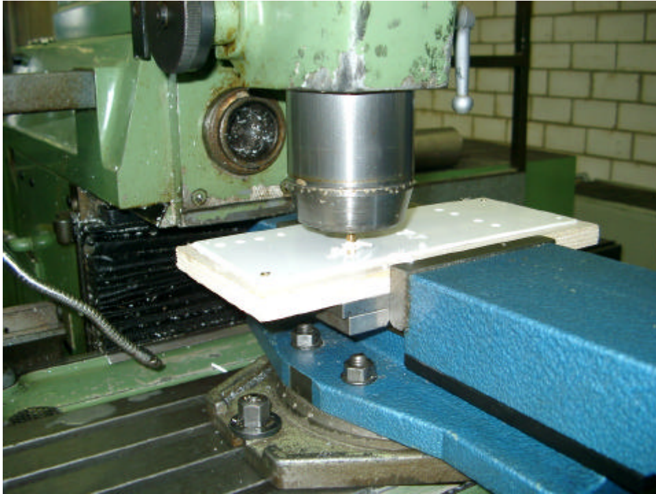
Vorbereitung der Prüfbuchsenträgerplatten
